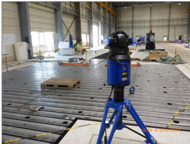
Abbildung 15: Laser-Tracker mit Plattenfeld
